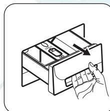
Потяните дозатор моющих средств на себя до упора. Положение А перегородки для моющих средств предназначено для порошкового моющего средства.
